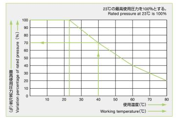
チューブの最高使用圧力は温度の上昇により下降してゆきます。(グラフ参照)高温流体や高温環境でのご使用時には特にご注意下さい。
