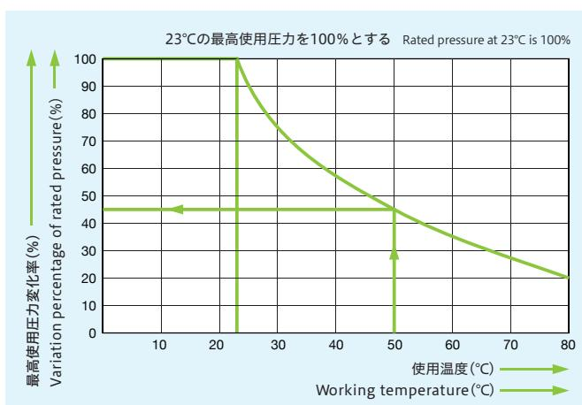
チューブの最高使用圧力は温度の上昇により下降してゆきます。(グラフ参照)
