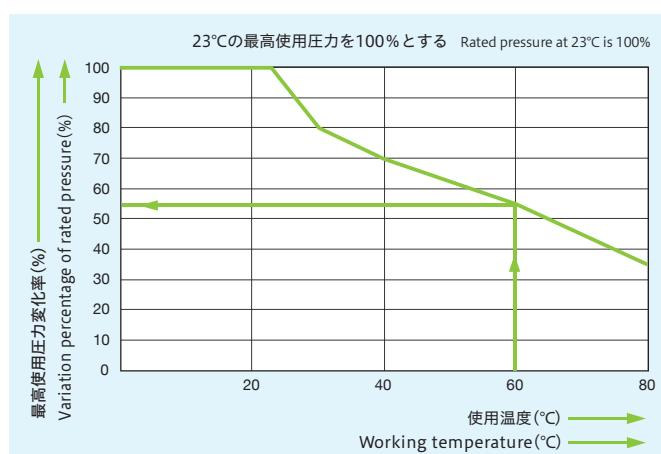
チューブの最高使用圧力は温度の上昇により下降してゆきます。(グラフ参照)
